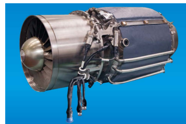
Перспективный малоразмерный двигатель AI-PBS-350
