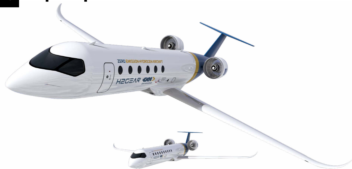
Демонстратор самолета с силовой установкой на базе топливных элементов по проекту H2Gear.
