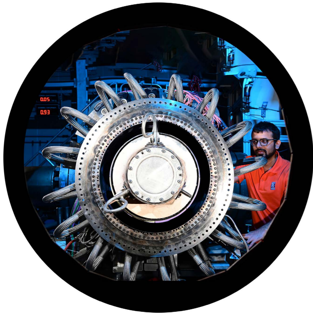
Испытания камеры сгорания двигателя Pearl 700 на 100% водородном топливе
