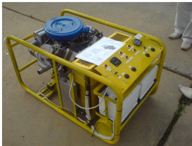
Рис. 10. Опытный образец дизель-стартер-генераторной установки
