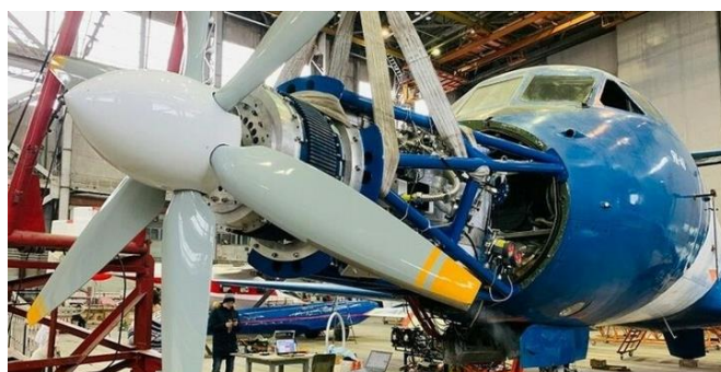
Рис. 1. Электрический двигатель для винта на Як-40ЛЛ
