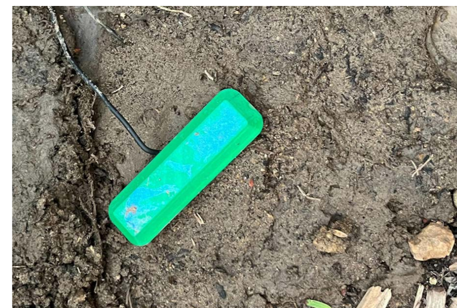
Микробный топливный элемент, зарытый в почву и вырабатывающий энергию
