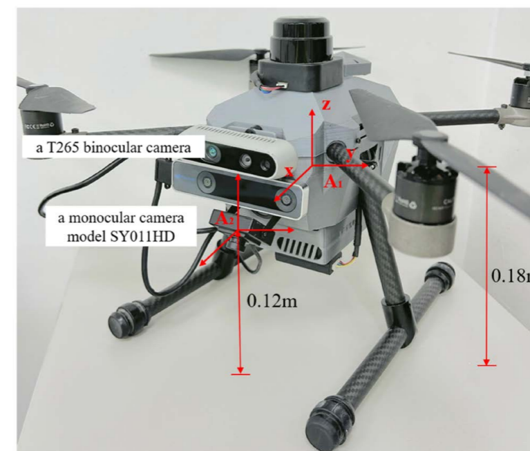
Монтажные положения двух камер. Центр беспилотника, известный как A1, расположен на центральной оси кадра, на высоте 0,18 м над землей. Координаты для A1 установлены на (0 м, 0 м, 0 м). Между тем, центр камеры SY011HD, A2, расположен на (0,08 м, 0 м, 0,06 м)
