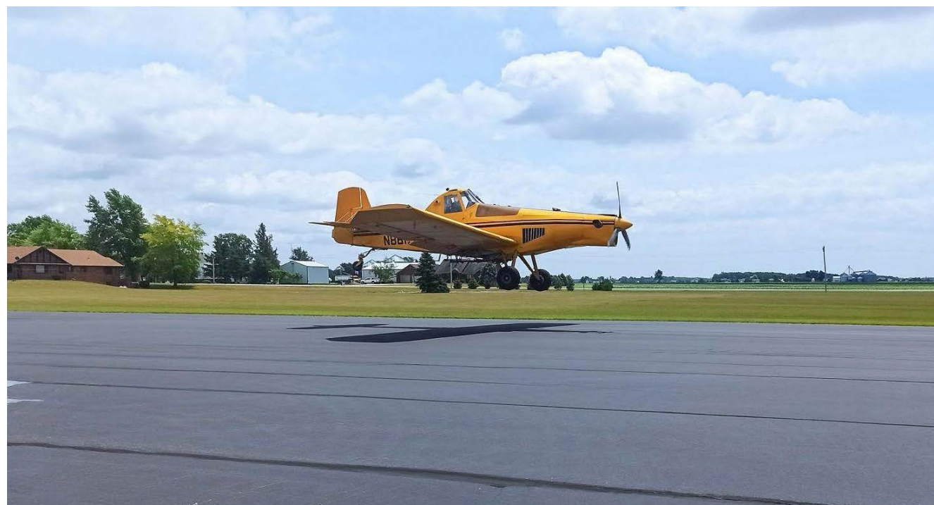
Сельскохозяйственный самолет Thrush с гибридной силовой установкой во время первого полета
